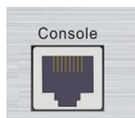
: 超级终端的 RJ45 连接端口
