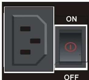
: 机箱后部电源插座和电源开关
