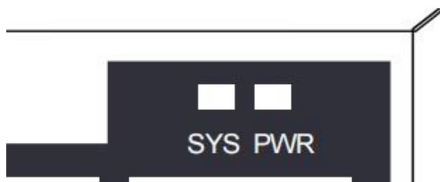
图 5-1 电源及系统指示灯
