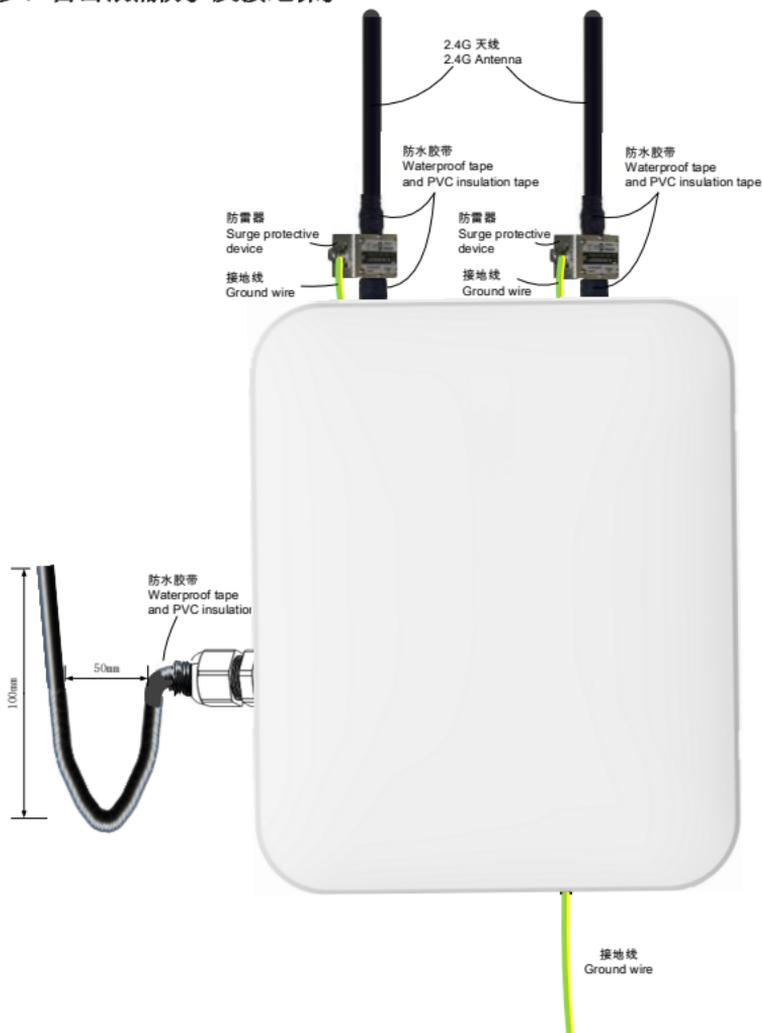
1、当使用PoE供电时，设备应已连接到网络上。请按上图顺序依次将防
